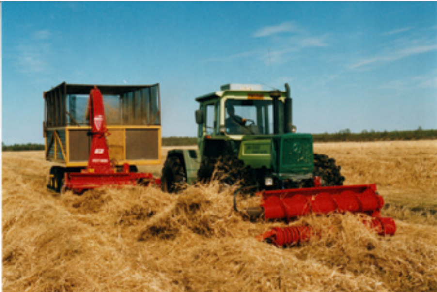
Kuva 5. Ruokohelven korjuuta toukokuussa 1997 tarkkuussilppurilla etukarheajan tekemältä yhdistelmäkarheelta. Korjuualue on turvetuotannosta pois jääneellä alueella Vapo Oy:n Hirvinevalla (Lindh ym. 2001). (Kuva: VTT Energia)
