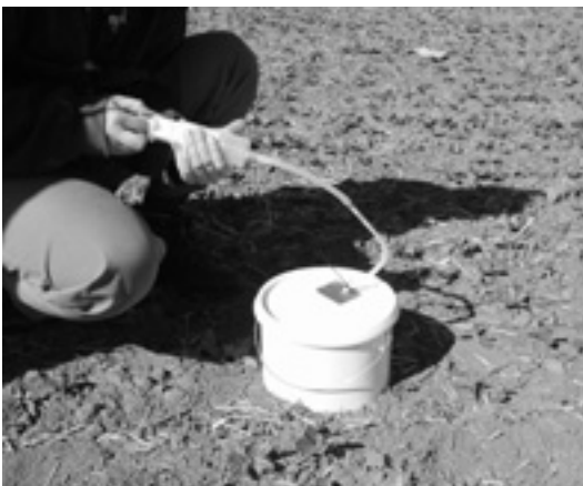
Kuva 3. Maahengitystä voidaan mitata suoraan pellolla suhteellisen yksinkertaisin välinein. (Kuva Merja Mylly)
